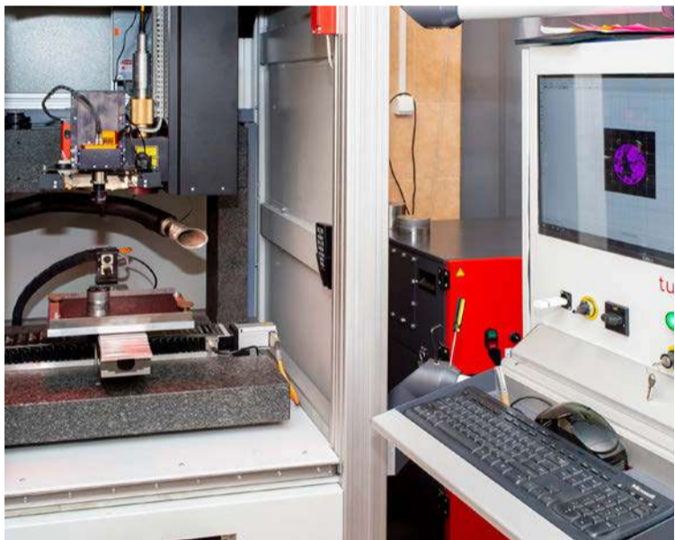
Станок для гравирования первичного инструмента будущих монет
